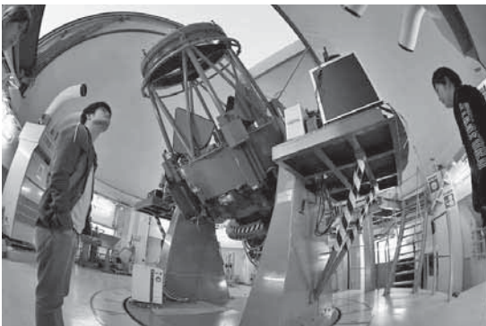
図2 口径1.5m かなた望遠鏡（旧・赤外シミュレータ）。架台は西村製作所製で、方位角回転速度はドーム屋根と共に毎秒5°と、このクラスの望遠鏡としては速い。望遠鏡鏡筒は三菱電機製。
